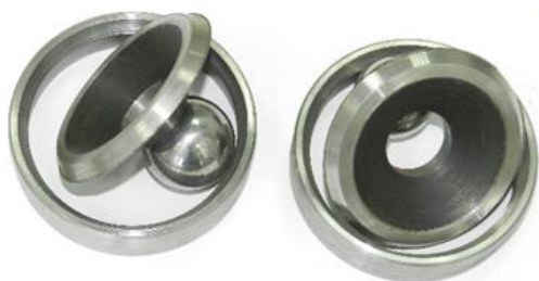
Разрушенные при срыве диафрагмы
