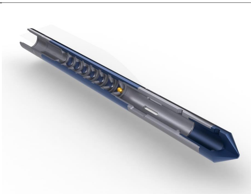
Сбрасываемый металлический шар перекрывает проходное сечение диафрагм П-94 «Геркулес»
